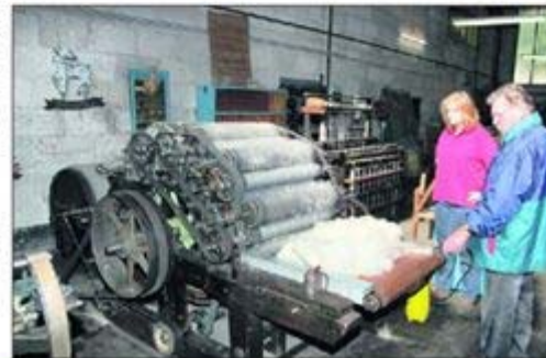
Anja Gottschalk und Heinz Omnitz halten die Krempelmaschinen zur Verarbeitung von Rohwolle für die Spinnerei am Laufen.
